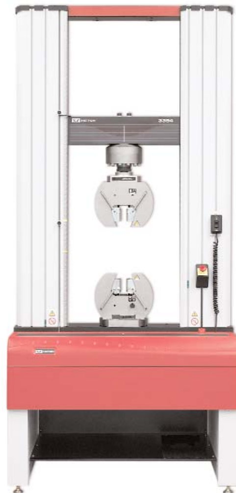
▲ Modelo 3384 de Instron en rojo magenta con mordazas neumáticas de acción de cuña
